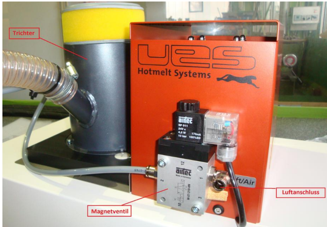
Magnetventil und Luftanschlusss extern an Pumpendom verbaut
