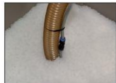
Richtig: Die Lanze ist tief ins Granulat gedrückt
