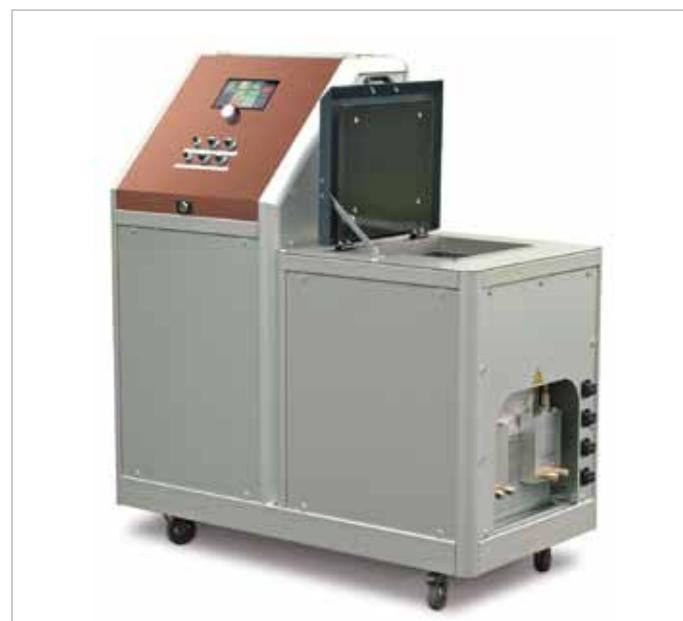
MaxMelt 50, 2 Zahnradpumpen 7,3 ccm, 4 Compact Schlauchanschlüsse
